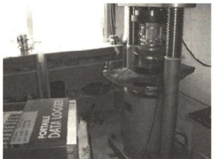
Photo. 7 圧縮強度試験状況
