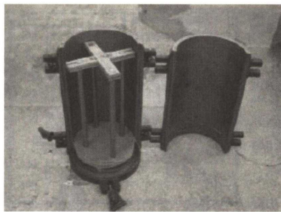
Photo. 9 鉄筋入り供試体
