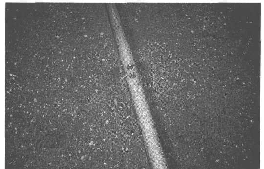
Photo. 3 実験土槽内の散水状況
