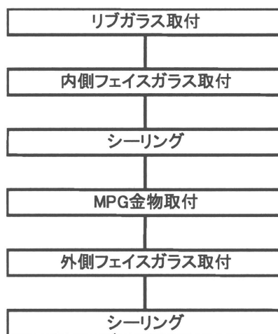
Fig. 12 ダブルスキン取付フロー
