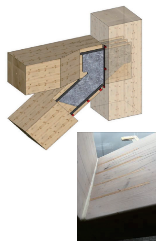
写真-16. ブレース接合部 (受領資料より)
