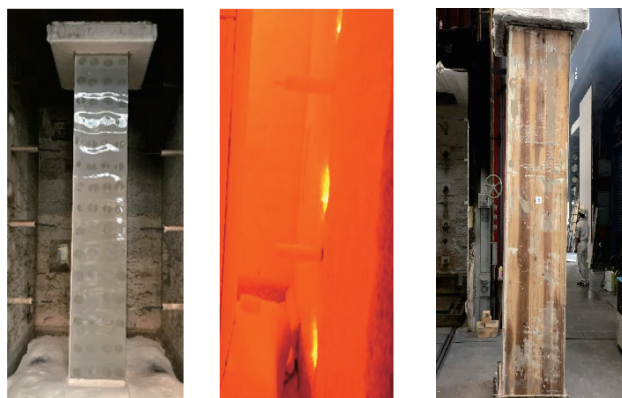
Fig.2 柱の耐火試験（加熱前・加熱中・加熱後）
