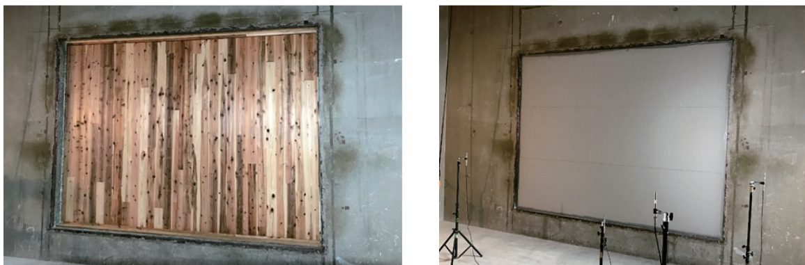
Fig.7 CLT 壁の実験状況（左：CLT 設置状況、右：空気音遮断性能の測定）
