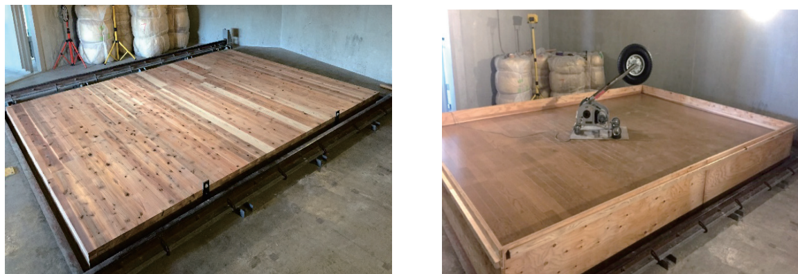
Fig.5 CLT 床の実験状況（左：CLT の設置状況、右：重量床衝撃音の測定）
